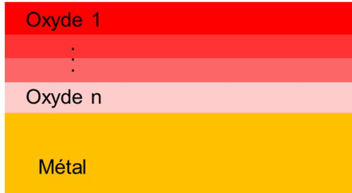
Figure II-3 : Schéma d'empilement de couches d'oxyde.
