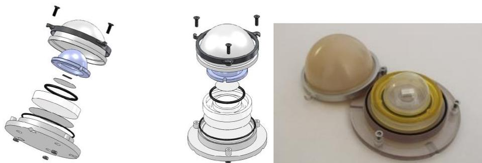
Figure II-15 : a) Schéma du montage double-dôme et b) photo du montage.
