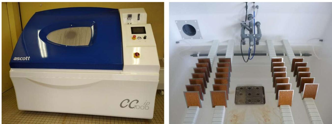
Figure 104 - Enceinte ASCOTT CC1000IP, vue d'ensemble (à gauche) et intérieur avec échantillons exposés (à droite).
