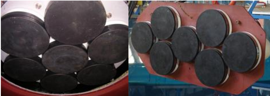
Figure 5-6 : Sondeur de sédiments du Pourquoi Pas ? (à gauche) et de l'Atalante (à droite) © Ifremer
