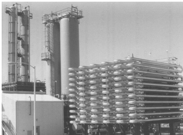
Figure 2. Réacteur tubulaire continu industriel (premier plan) pour le dimérisation d'oléfines (Dimersol).
