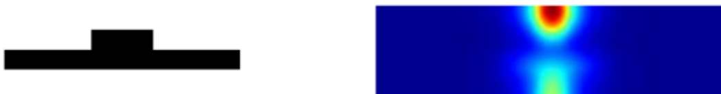
FIGURE 5.7 – Représentation de la structure abrupte (gauche) et de sa carte de champ (droite). On passe directement du guide d'onde de largeur 120 nm au guide d'onde de largeur 450 nm sans chercher à faciliter la transmission. L'épaisseur totale de la structure est de 200 nm. La fonction de coût vaut 0.29429.
