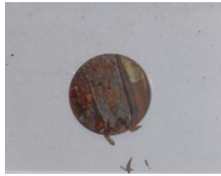
Figure II-10. Photographie macroscopique d'un échantillon présentant la délamination des filaments déposés à la surface de TA6V (1 cm de diamètre) après traitement thermique à 800 °C
