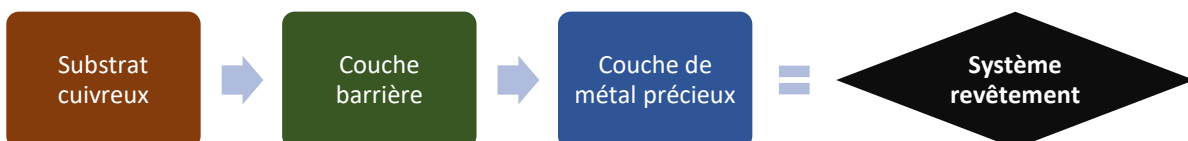
Figure 25 : Différentes couches d'un contact électrique
