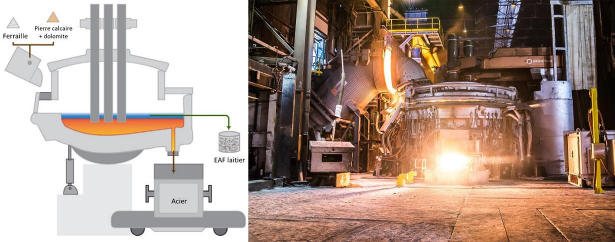
Figure 1.5 : Schéma d'un four à arc électrique (gauche) [10] et photo du four à arc électrique fabriqué par Primetals Technologies, implanté sur le site de l'Acciaieria Arvedi en Crémone – Italie, de capacité de production de 1,4 millions de tonnes/an [12]
