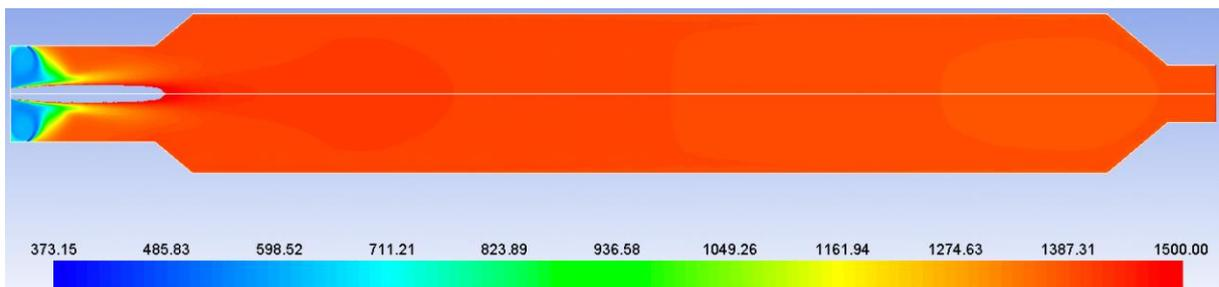
Figure 2.12 : Profil de température (K) de la configuration 1 du réacteur de 5m<sup>3</sup> avec un angle d'injection de 45°
