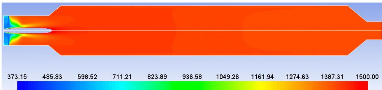
Figure 2.13 : Profil de température (K) de la configuration 1 du réacteur de 5m<sup>3</sup> avec un angle d'injection de 90°
