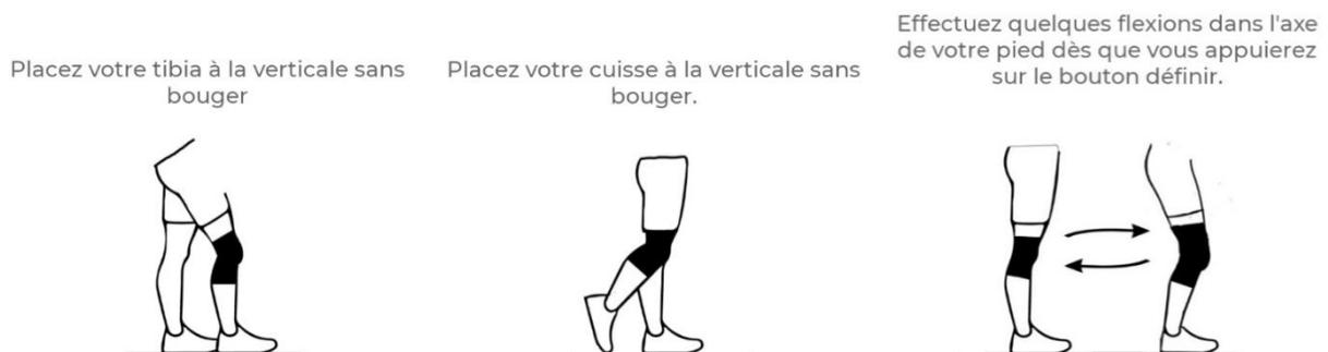
**Figure 16** : Procédure de calibration de la genouillère
