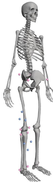
Figure 32 : Localisation des 10 marqueurs anatomiques pour la définition des segments osseux (rose) et des 2 clusters de 3 marqueurs pour la cinématique du fémur et du tibia (bleu)
