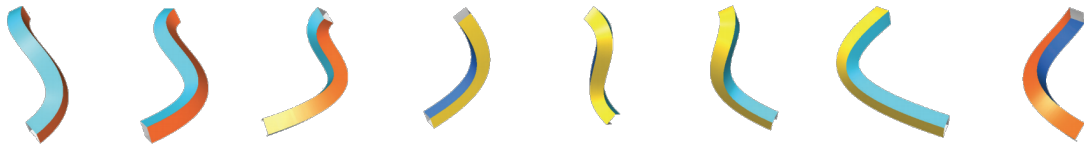
FIGURE 2.21 – Extrusion d'une surface le long d'une courbe. [Wang et al., 2008]
