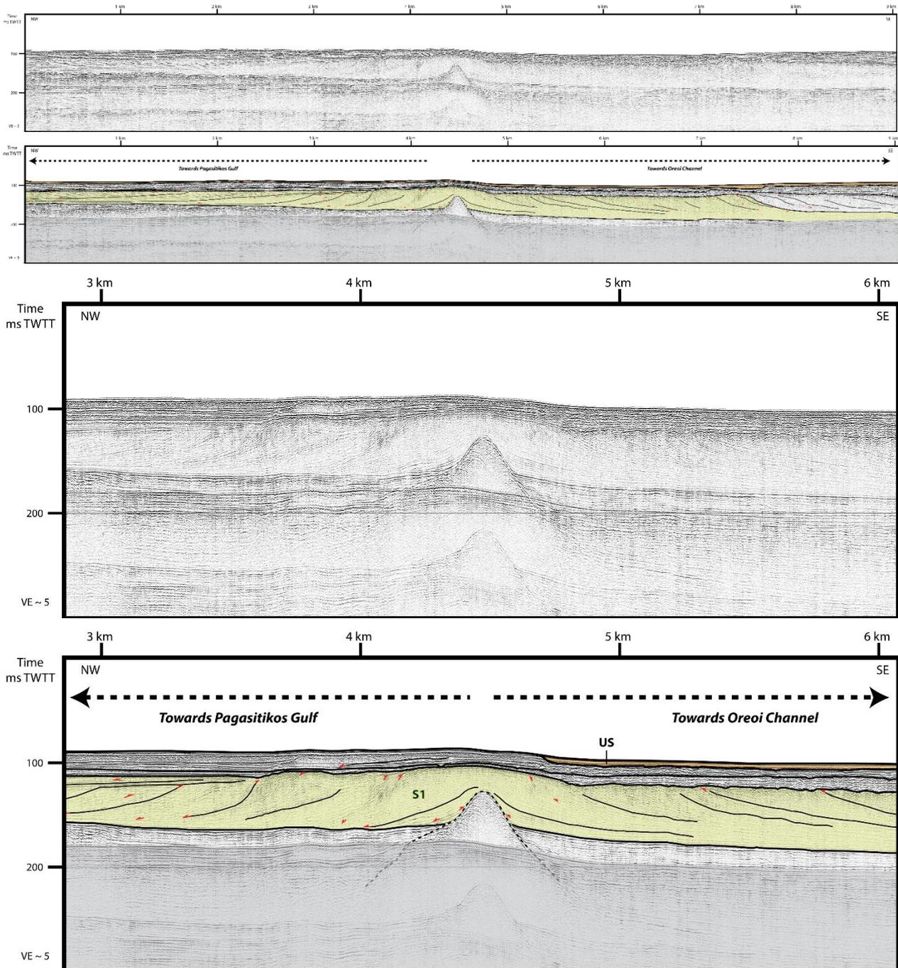
**Figure 5.9 :** Profil sismique WAT17\_103, localisé sur la Figure 5.2, et un zoom au milieu du profil montrant les deux directions de pendage des clinofformes vers le Golfe Pagasitique et vers le Chenal d’Oreoi.
