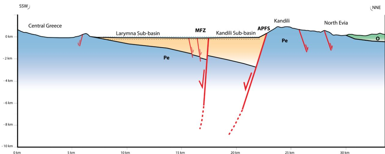
**Figure 4.22** : Coupe schématique n°4 orientée SSW-NNE à travers le Bassin Oriental du Golfe Nord Eubée, localisée sur la Figure 4.1. Le rectangle en tirets matérialise la position d'un des profils sismiques Air-gun. APFS : Aedipos Politika Fault System ; MFZ : Melouna Fault Zone ; O : Ophiolites ; Pe : séries pélagoniennes.
