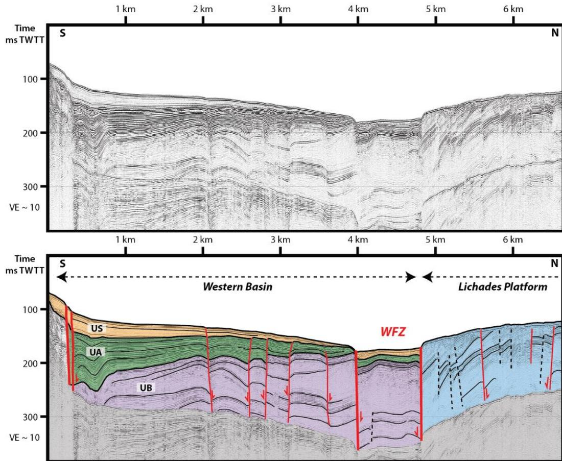
**Figure 3.10** : Profil sismique WAT17\_221 (localisation Figure 3.4) et son interprétation illustrant la partie orientale du Bassin Occidental (Western Basin) ainsi que la plate-forme de Lichades. Ces deux zones aux faciès sismiques très différents sont séparées par une faille normale à pendage Sud appartenant à la Western Fault Zone (WFZ). UA : Unité A ; UB : Unité B ; US : *Upper Sequence*.
