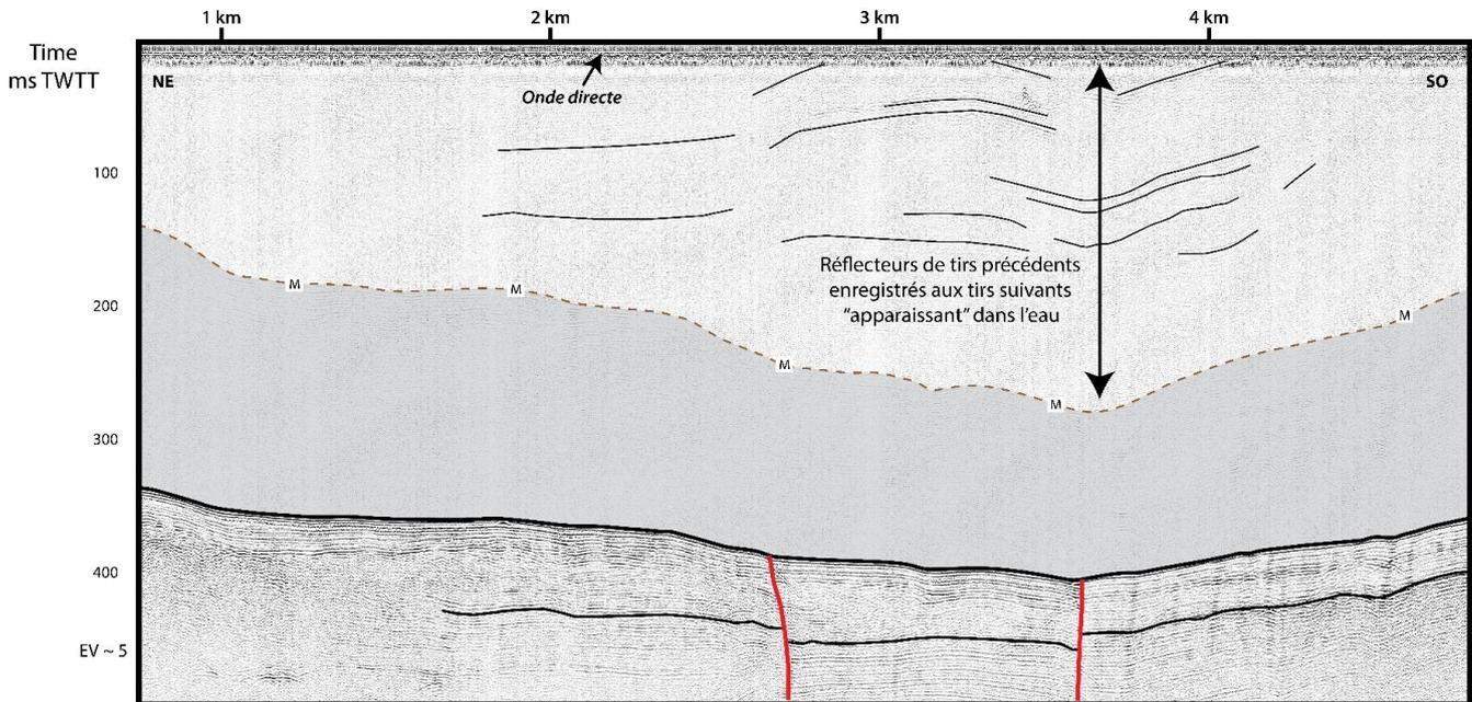
**Figure 2.20** : Extrait du profil WAT17\_204 où des réflecteurs dans l'eau ont été interprétés comme étant des réflexions de tir précédent enregistrées lors du tir suivant. Localisation sur la Figure 2.8.
