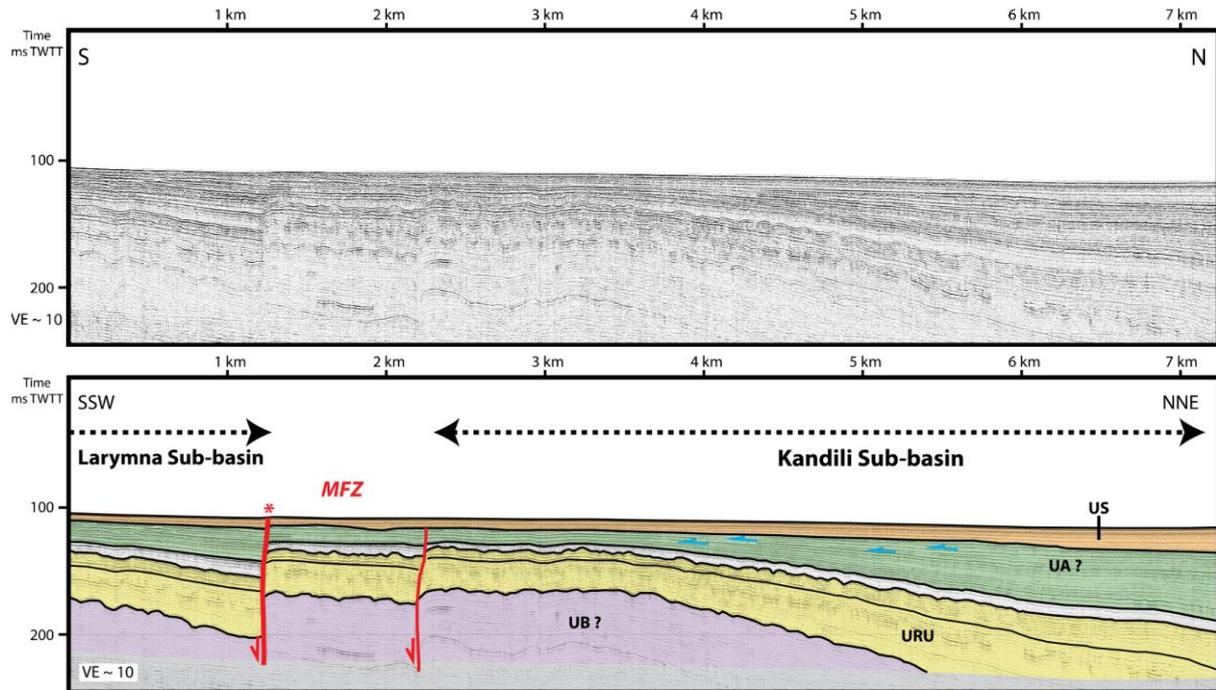
**Figure 3.13** : Profils sismique WAT17\_174 (localisation Figure 3.4) et son interprétation illustrant la répartition de l'*Upper Sequence* (US) dans les deux sous-bassins de Larymna et du Kandili séparés par la Melouna Fault Zone (MFZ). URU : Undulated Reflectors Unit.
