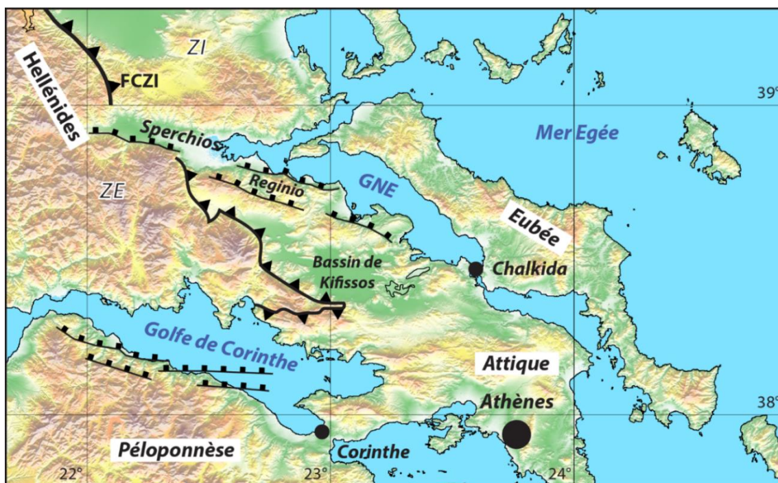
Figure 1.21 : Carte des cinq grabens principaux : le Golfe de Corinthe, le Golfe Nord Eubée (GNE), bassin de Régino, bassin du Sperchios et le bassin de Kifissos et des principales failles normales contrôlant ces grabens. FCZI : Front de Chevauchement des Zones Internes, ZE : Zones Externes, ZI : Zones Internes.
