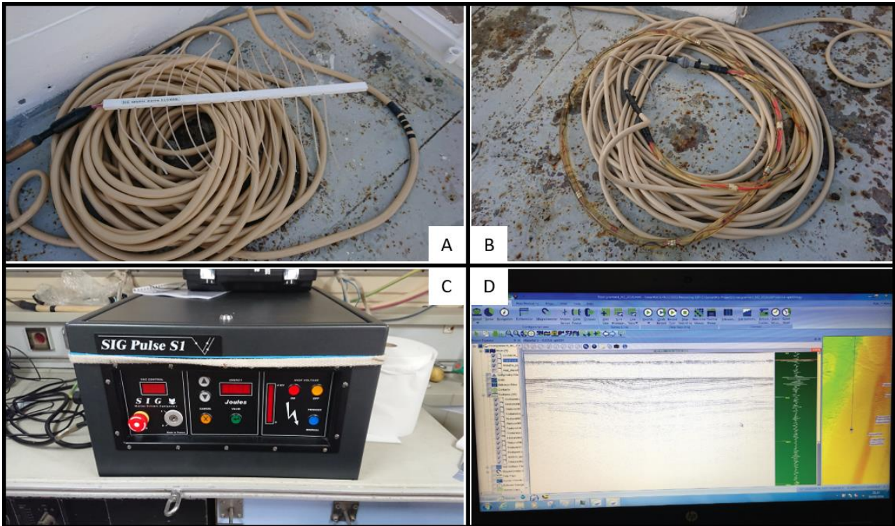
Figure 2.6 : Dispositif d'acquisition de type Sparker. A : le peigne, B : la flûte monotrace, C : la génératrice SIG, D : acquisition en cours sur le logiciel SonarWiz, photographie de Jollivet-Castelot (2018).
