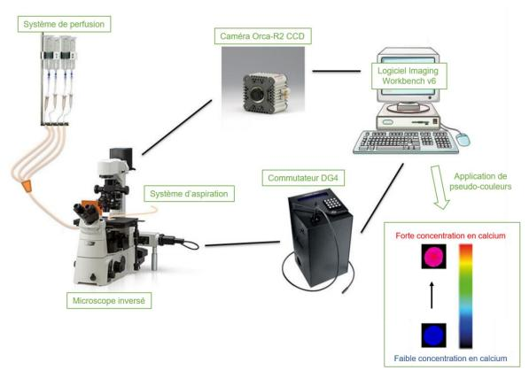
Figure 38 : Représentation schématique de l'installation d'un poste d'imagerie calcique et visualisation des variations de la [Ca<sup>2+</sup>]<sub>i</sub> par l'application de pseudo-couleurs grâce au logiciel Imaging Workbench v6.
