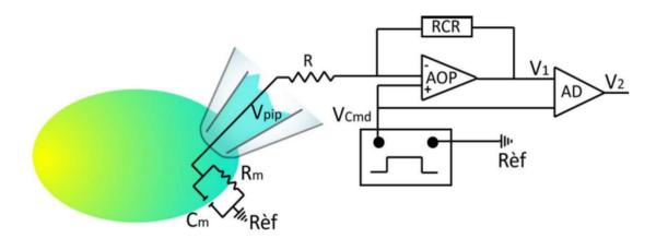
Figure 35 : Fonctionnement de l'amplificateur de patch. AOP : amplificateur opérationnel ; RCR : boucle de contre-réaction ; AD : amplificateur différentiel ; Vpip : potentiel de pipette ; Vcmd : potentiel imposé par l'expérimentateur (Goulu, 2015).
