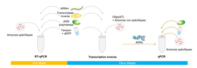
Figure 39 : Schéma des mix de RT-qPCR en une et deux étapes (Modifié d'après ThermoFischer.com, 2021).
