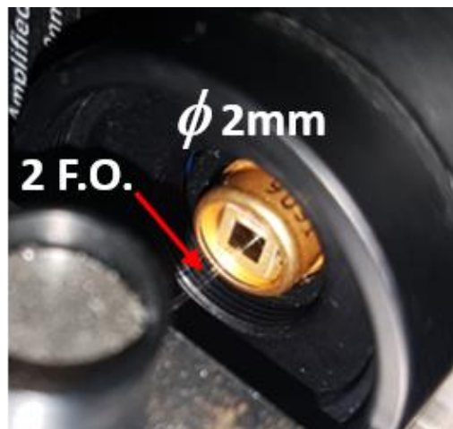
Figure 2 – 20 : Sommation de signaux optiques, deux fibres optiques (F.O) éclairent une photodiode de 2mm de diamètre
