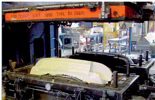
Figure I.2 – Moulage d'un pare-chocs en SMC [10]
