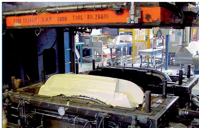
Figure I.2 – Moulage d'un pare-chocs en SMC [10]
