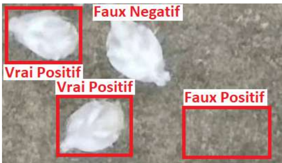
FIGURE 4.1 – Représentation de ce que l'on appelle un Vrai Positif, un Faux Positif et un Faux Négatif
