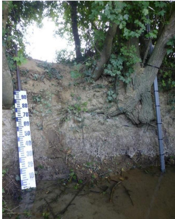
Figure 44 : Photographie de la station de mesure des débits mise en place à l'exutoire du Gélon avec à gauche l'échelle limnimétrique pour la lecture à l'œil nu du niveau d'eau et à droite la sonde immergée qui télétransmet les hauteurs d'eau mesurées
