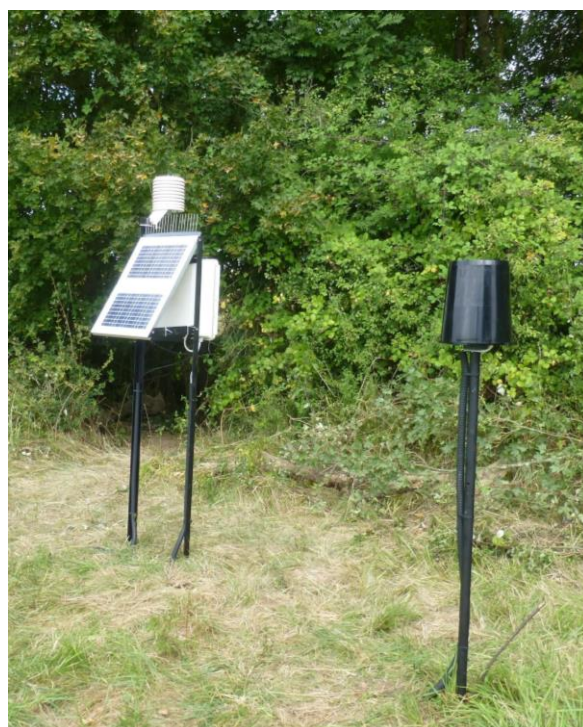
Figure 46 : Photographie de la station de mesure des températures et des précipitations mise en place à l'exutoire du Gélon avec à droite le pluviomètre et en haut à gauche le thermomètre qui est au-dessus de la station qui permet de télétransmettre l'ensemble des données mesurées
