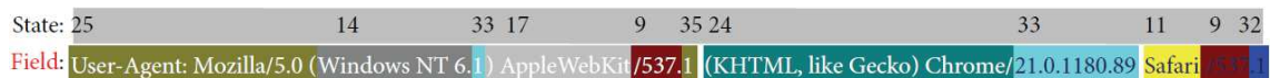
FIGURE 5.10 – Exemple de trame HTTP segmentée en champs à l'aide de l'algorithme de Viterbi
