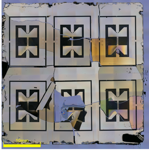
Figure 4.4 – Cliché de microscopie optique d’un résonateur (design n°4) réalisé par gravure réactive ionique profonde.
