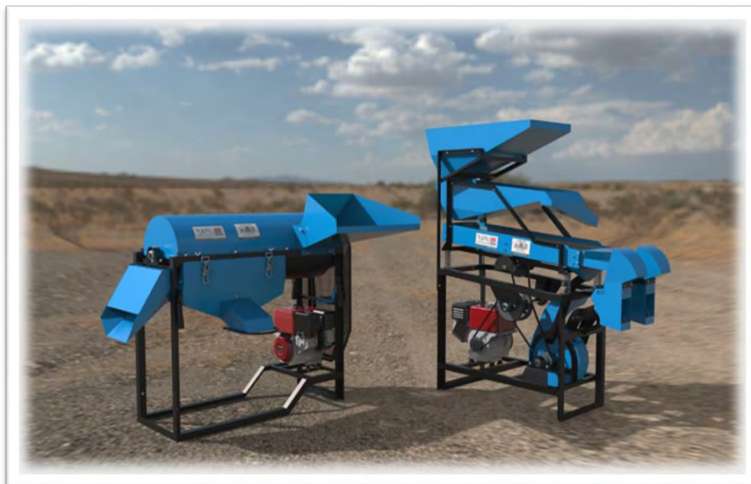
Figura 78: Trilladora y aventadora de quinoa desarrollada por el IPAF NOA y validada por campesinos de la CUM.
