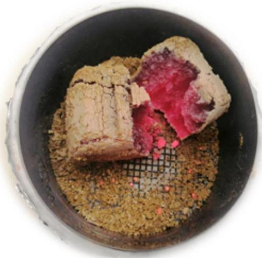
Figure 1. 9. Incandescence due aux réactions hétérogènes.
