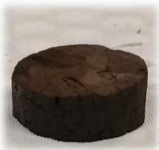
Figure 3. 24. Échantillon de lignite utilisé pour la mesure de la perméabilité.
