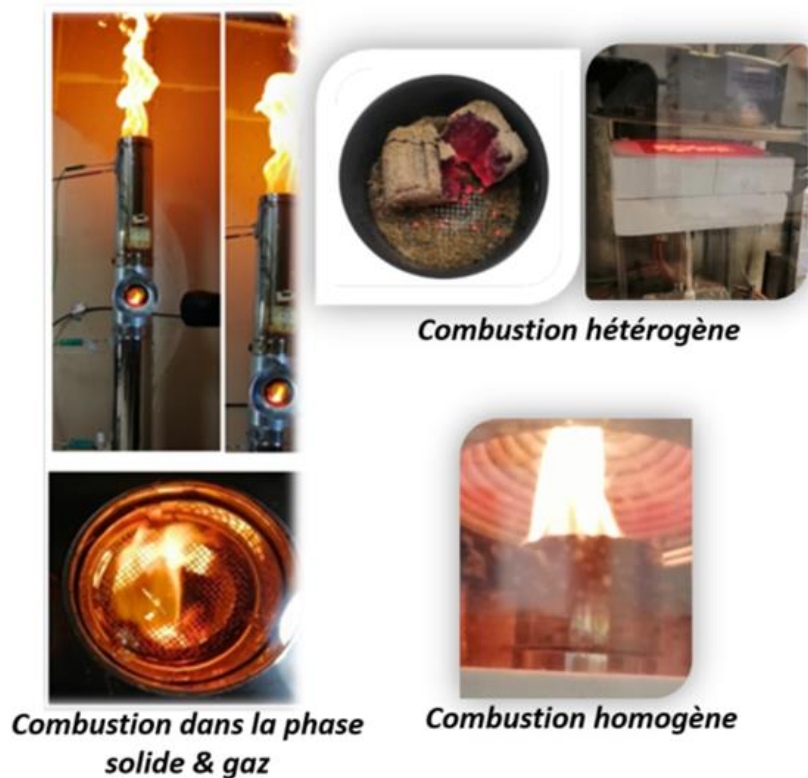
Figure 1. 26. Différents types de combustion du lignite, photos prises au cours des campagnes expérimentales réalisées durant la présente thèse.
