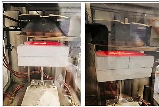
Figure A-4. Inflammation du lignite en cône calorimètre ouvert.
