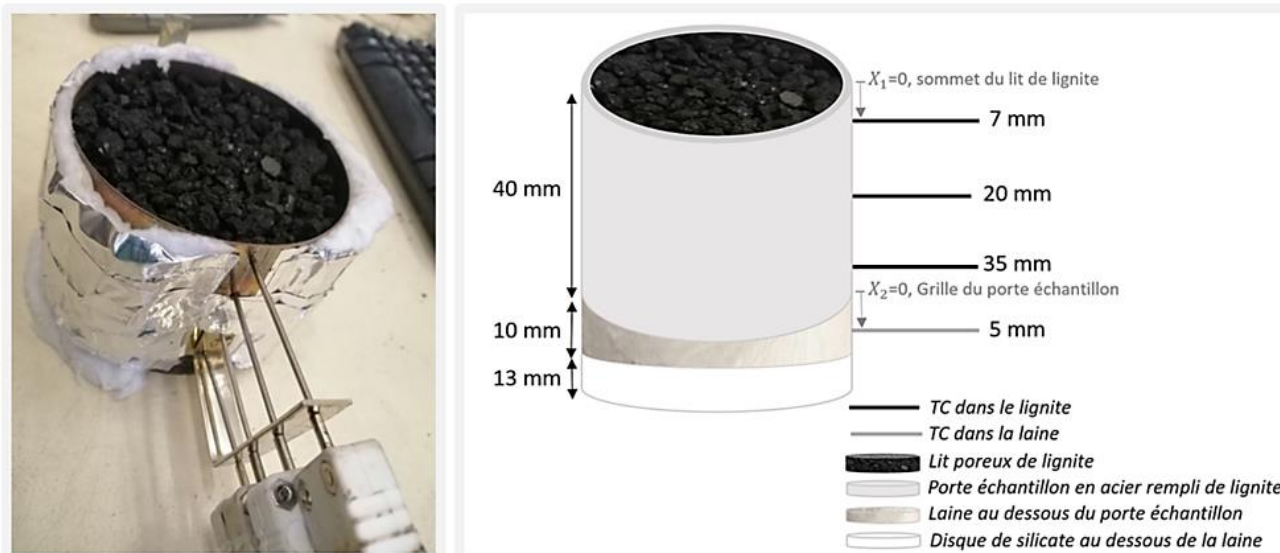
Figure 3. 4. Présentation et schéma du PE isolé et des thermocouples lors des tests en CCAC.
