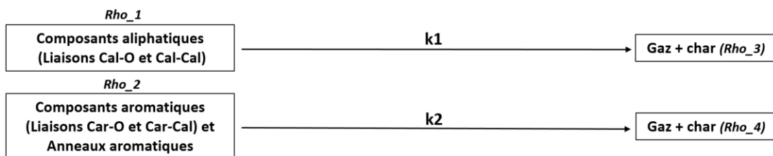
Figure 2. 16. Mécanisme de pyrolyse du lignite parallèle simplifié proposé.
