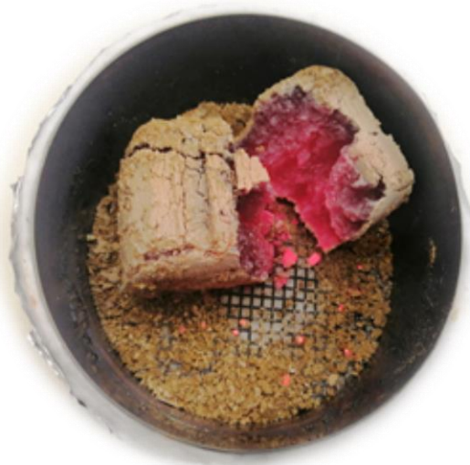
Figure 1. 9. Incandescence due aux réactions hétérogènes.
