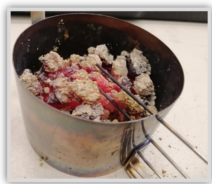
Figure 4. 3. PE non isolé avec thermocouples lors d'un test en banc CGT.
