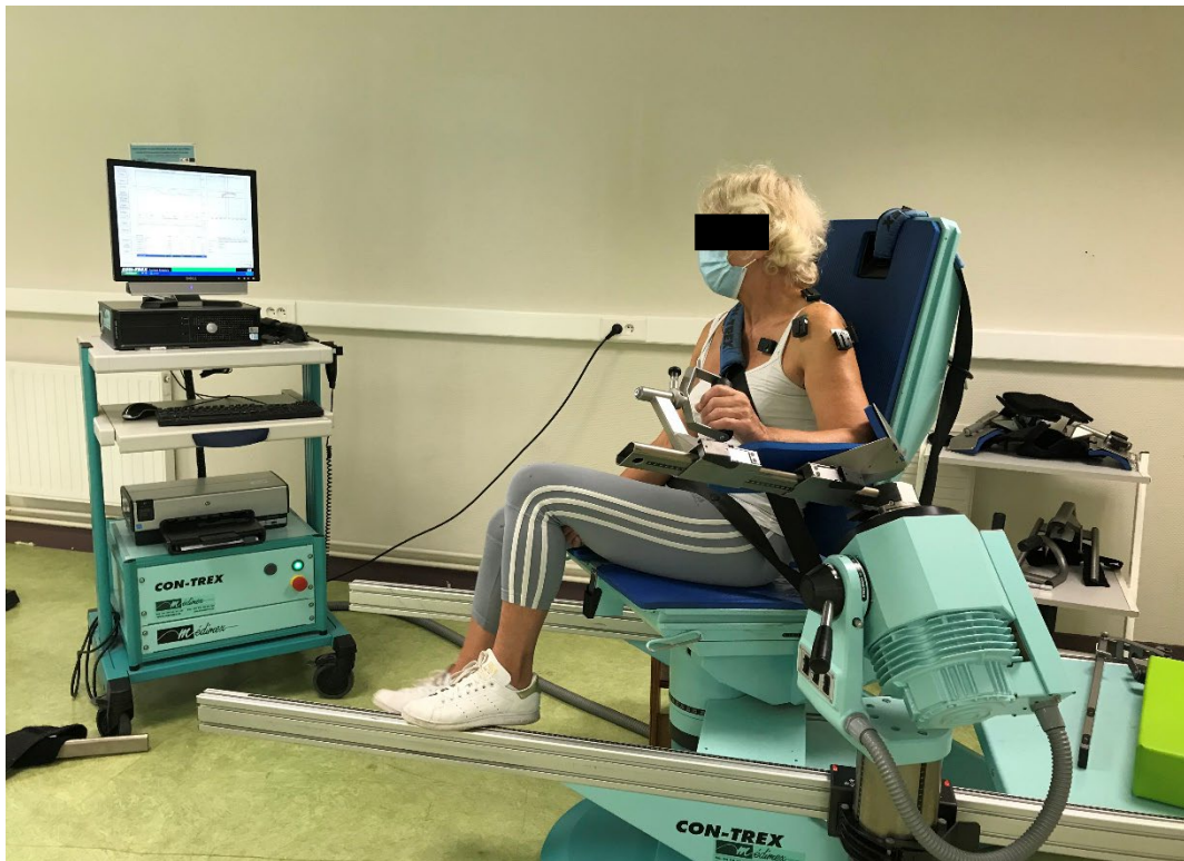
Figure 22 : Installation pour les mesures en rotation
