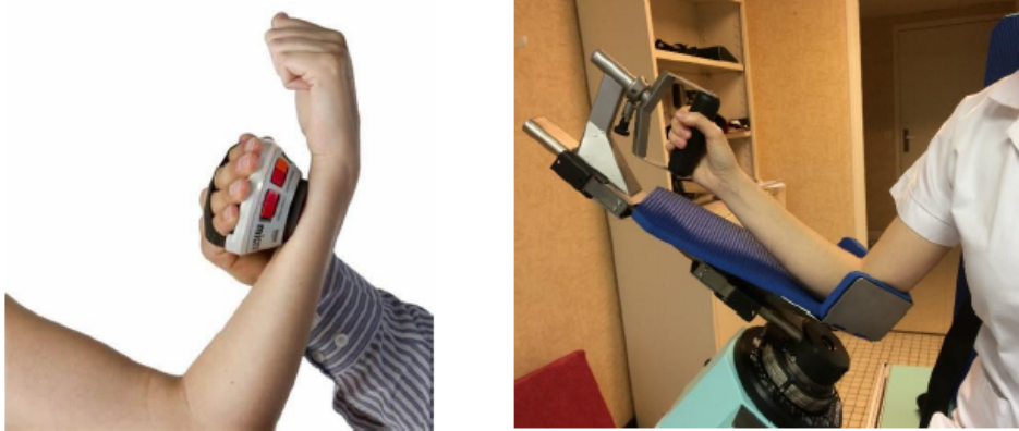
Figure 1 : Illustration des dispositifs Microfet ® (à gauche) et Contrex ® (à droite) permettant l'évaluation de votre force musculaire.
