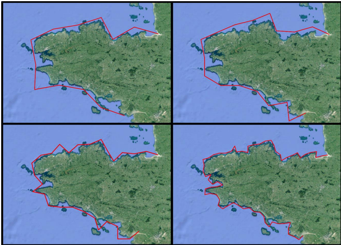
Figure 10 - Dimension fractale de la côte Bretonne. Plus l'échelle de l'outil de mesure est faible, plus la distance mesurée augmente.
