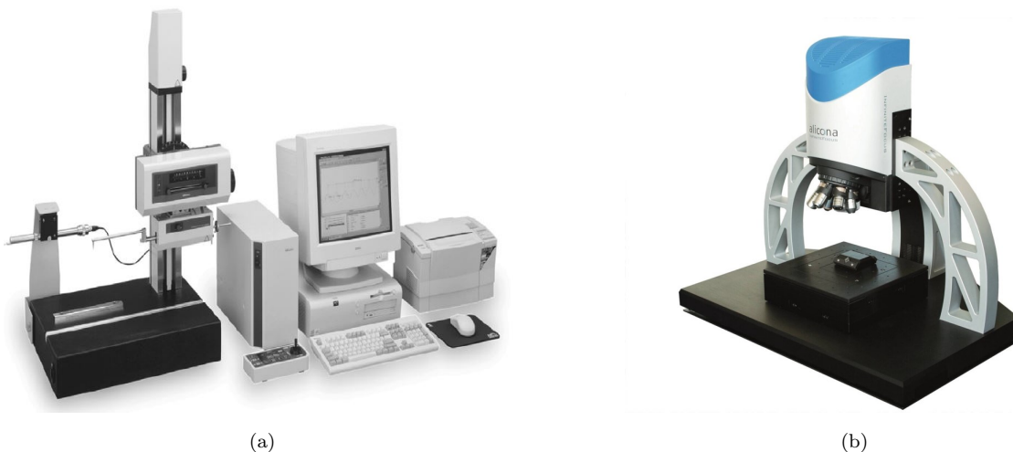
FIGURE 1.1 – Outils de mesure de topographies : (a) à stylet [3] (b) optique
