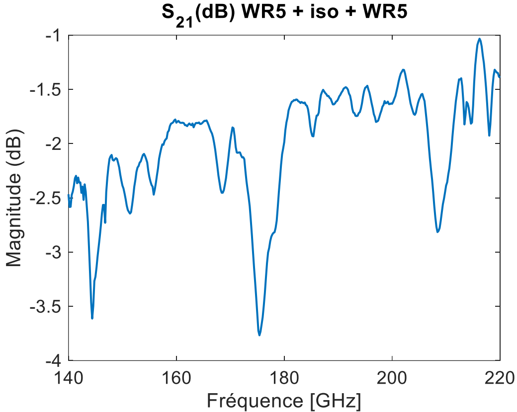
Figure 163 : Paramètre S_{21} de l'ensemble {tronçon WR5-isolateur-tronçon WR5}.
