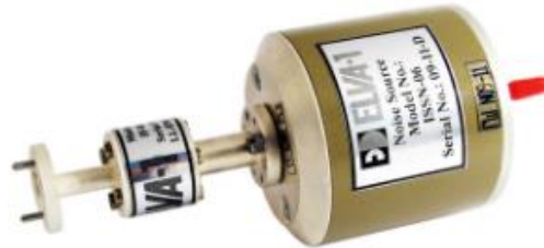
Figure 12 : Source de bruit ELVA ISSN-06 disponible à l'IEMN.
