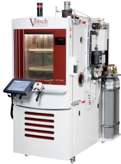
Figure 2-3: Enceinte climatique Vötsch 340 Litres.
