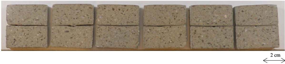
Figure 3-33: Différence du mode de rupture en fonction des temps d'attente entre les couches « TAC » sur des échantillons imprimés moulés.
