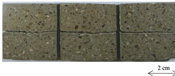
Figure 4-14: Différence du mode de rupture en fonction du « TAC » pour T=20^{\circ}\text{C} / \text{HR}=50\% .
