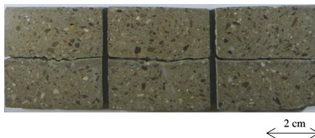
Figure 4-14: Différence du mode de rupture en fonction du « TAC » pour T=20^{\circ}\text{C} / \text{HR}=50\% .
