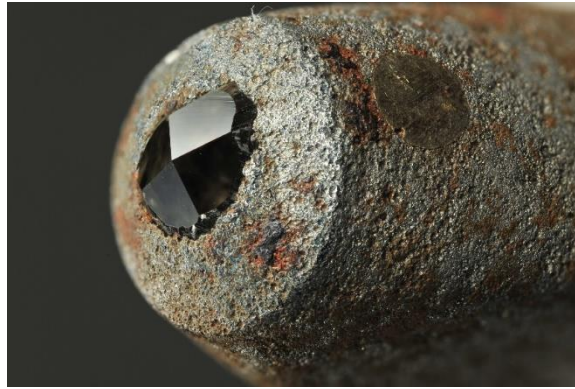
Figure 1-18 : Forme géométrique d'une pointe Vickers.
