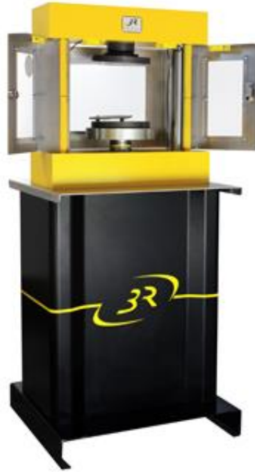
Figure 2-18: La presse hydraulique couplée « 3R » utilisée pour réalisation des essais de compression.
