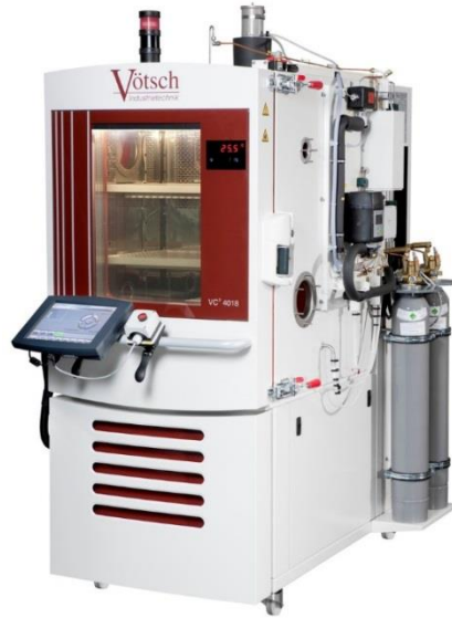
Figure 2-3: Enceinte climatique Vötsch 340 Litres.
