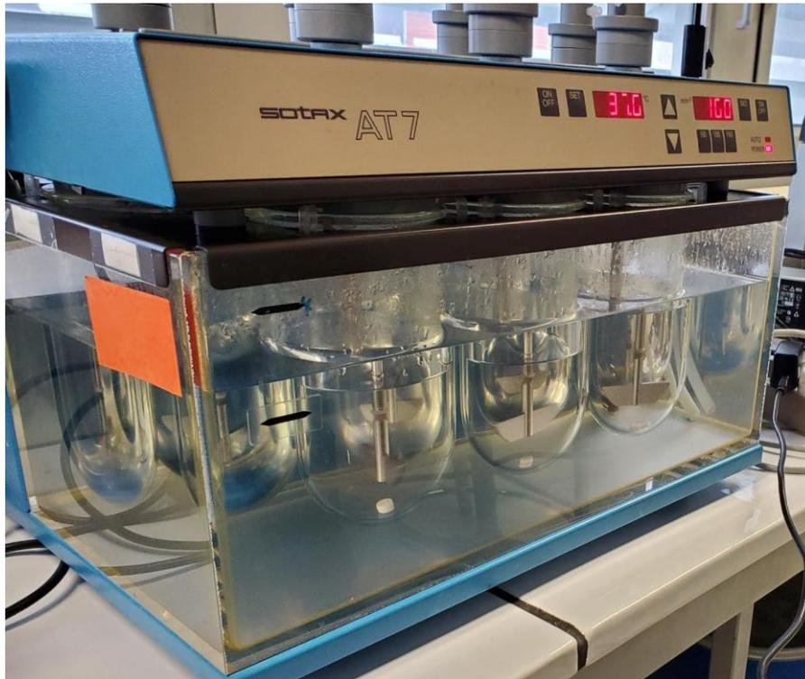
*Figure 2.9 - Appareil de dissolution : Sotax AT7*
