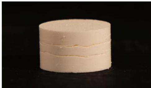
*Figure 3.20 - Photographie d'un Tab-in-Tab Amidon-Lactose (8-11,28 mm, 150 MPa)*
