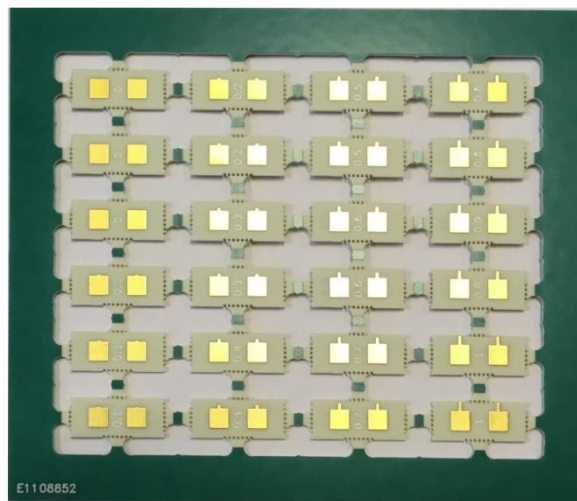
Figure IV-8 : Cellules unitaires double fabriquées par Eurocircuits.
