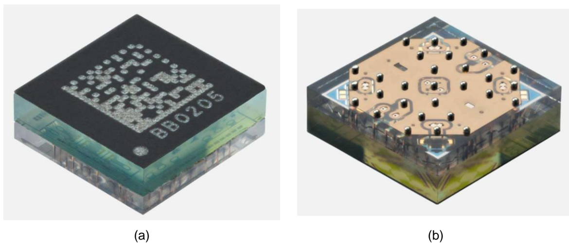
Figure I-17 : MEMS RF SP4T de la société Menlo Micro, (a) vue de dessus, (b) et vue de dessous [4].
