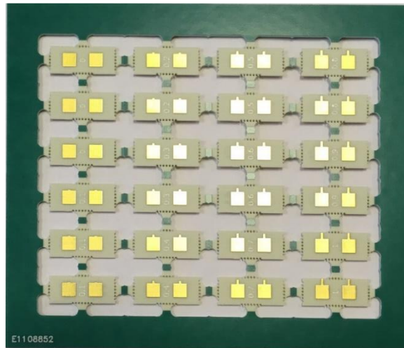
Figure IV-8 : Cellules unitaires double fabriquées par Eurocircuits.
