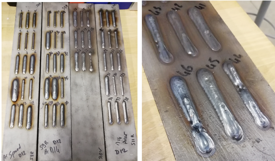
(a) Exemples de cordons réalisés dans le cadre du plan d'expérience en X90-IG
