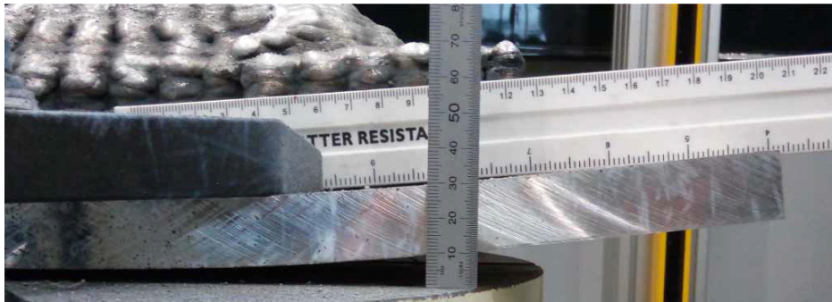
FIGURE 1.16 – Déformation du substrat initialement plan après une fabrication en WAAM [6]
