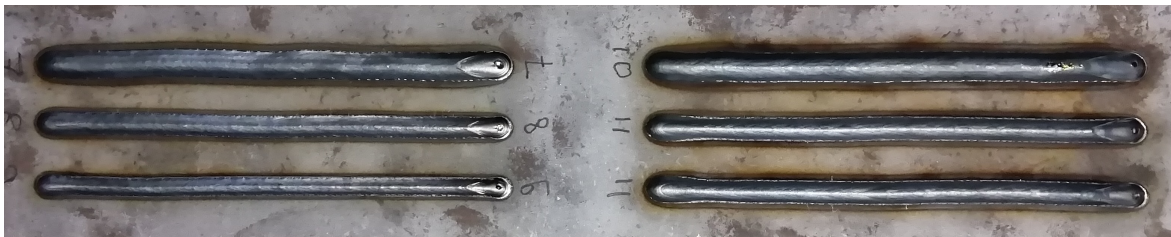
FIGURE 2.6 – Cordons fabriqués en acier G3Si
