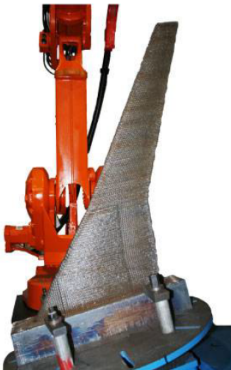
(b) Aile pour essais en soufflerie [7]
