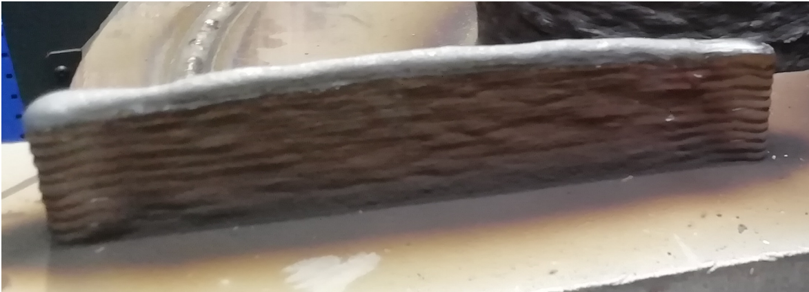
FIGURE 4.20 – Mur fin fabriqué
