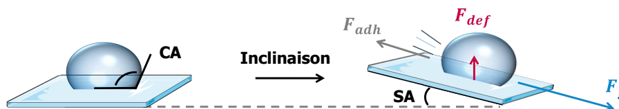
Figure 1.8. Schéma décrivant le glissement d'une goutte sur une surface inclinée d'un angle SA avec l'ajout de la force de déformation verticale F_{def} .
