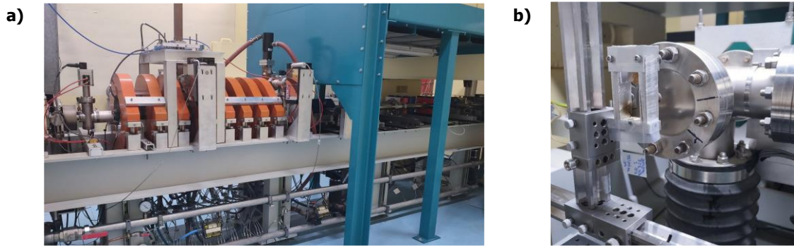
Figure 6.6. a) Photographie du LINAC ALIENOR et b) lame de verre, après revêtement réalisé à RH = 85\% , rinçage H_2O+iPrOH , placée devant le faisceau d'électrons.
