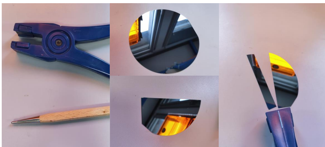
Figure 2.10. Photographies de la pince et de la pointe en diamant (à gauche) utilisées pour découper les wafers de silicium (au milieu) et de la bande finale obtenue après découpe (à droite).
