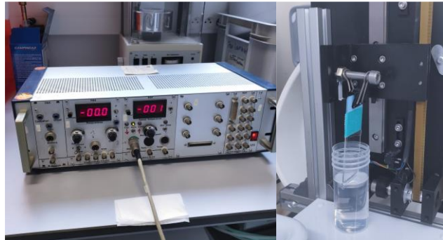
Figure 2.12. Photographies de l'appareil utilisé pour le dépôt du revêtement par immersion avec le contrôleur de vitesse (à gauche) et le bras automatisé tenant une lame de verre en immersion dans une solution (à droite).
