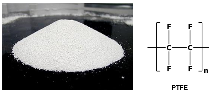
Figure 1.10. Aspect macroscopique (à gauche) et formule développée (à droite) du PolyTétraFluoroEthylène (PTFE).
