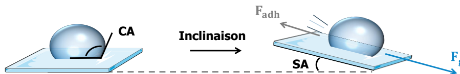
Figure 1.7. Schéma décrivant le glissement d'une goutte sur une surface inclinée d'un angle SA , pour F_g \geq F_{adh} .
