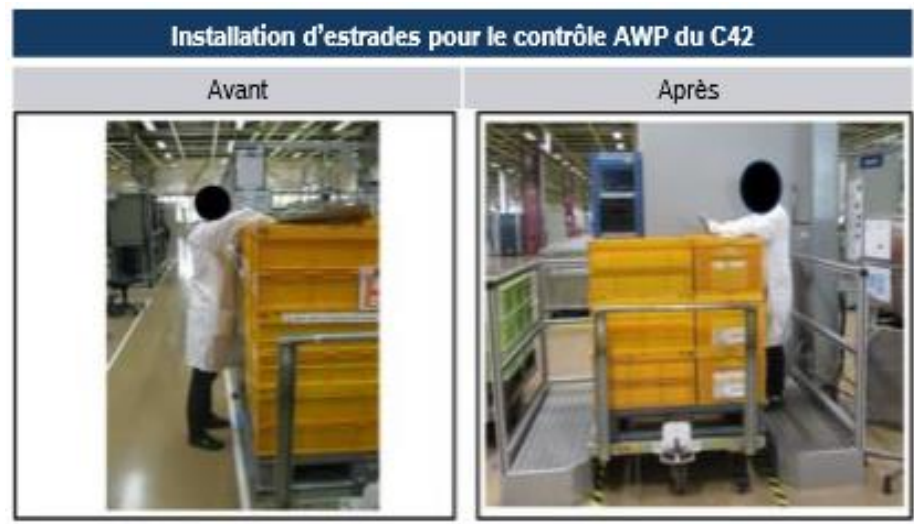
Figure n° 52 : Installation d'estrades pour le contrôle en production
