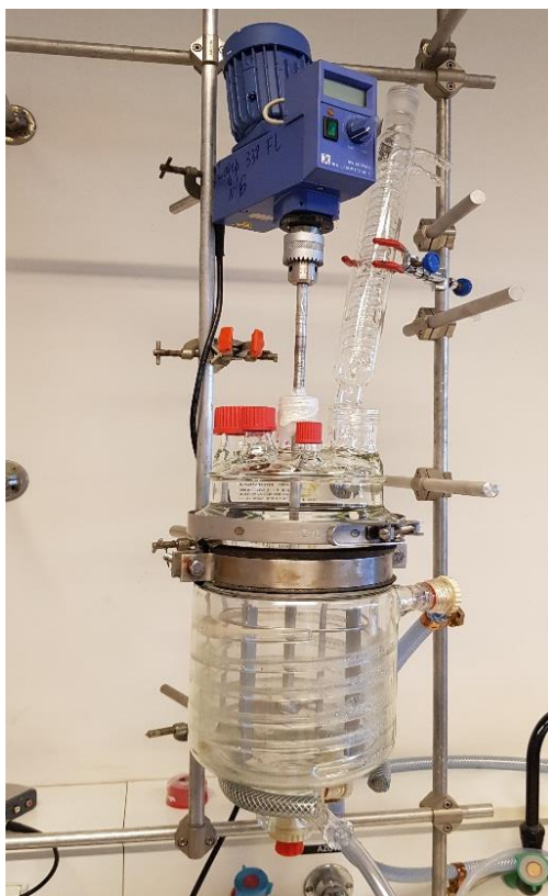
Figure II. 2. Dispositif expérimental pour la fabrication de la forme métastable \alpha
