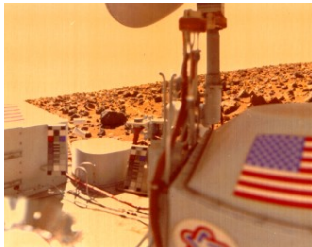
FIGURE I.12. Photographie prise depuis l'atterrisseur de Viking 2, montrant une partie des instruments et la plaine d'Utopia Planitia. Les deux générateurs RTG se situent au premier plan et au second plan à gauche. Au centre, le petit caisson blanc renferme le sismomètre, et à droite se trouve l'antenne de communication. Les différents éléments de couleurs (drapeau américain, grille colorée et logo) ont permis d'ajuster les couleurs de l'image ( crédits photo : NASA).
