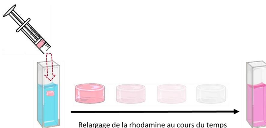
Figure 2.11 : Représentation schématique du relargage progressif de la rhodamine dans le bain de PBS.
