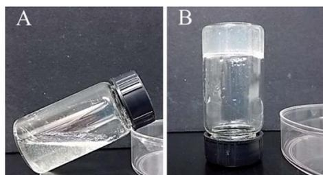
Figure 1.35 : Solution de chitosane à 3 wt% dans un mélange urée/NaOH ; (A) Avant immersion, (B) Après immersion 2 minutes dans un bain à 45 °C<sup>28</sup>.
