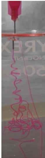
Figure 7.23 : Photo d'un essai d'injection dans un bain de PBS à 37 °C d'une solution d'ALG1-N45 à 5 wt% PBS (25 G,  $v = 50$  mm/min, soit  $Q = 0,92$  mL/min).
