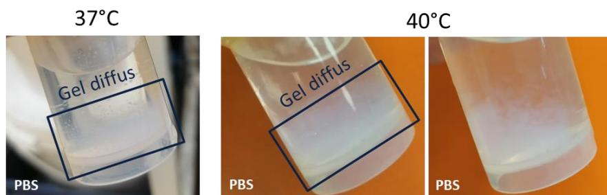
Figure 7.26 : Gels d'ALG2-N45 à 10 wt% en milieu PBS, au bout de 24 h ; (Gauche) 37 °C, (Droite) 40 °C.
