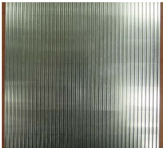
(d) Endfire repeater reflect-array [57].
