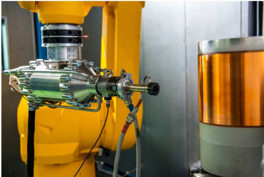
FIGURE 2.5. – Pistolet Impact Spray System 5/11 utilisé au CEA
