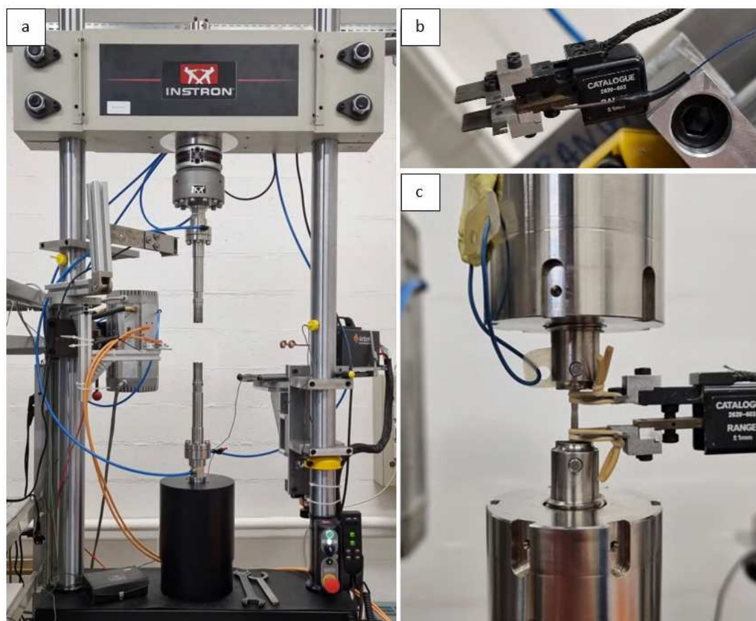
FIGURE 2.18. – Machine d’essai de traction Instron 8862 (a), extensomètre utilisé pour les essais (b) et montage final d’une éprouvette (c)
