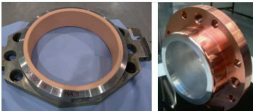
FIGURE 1.18. – Pièces axisymétriques contenant des dépôts en cold spray [115]
