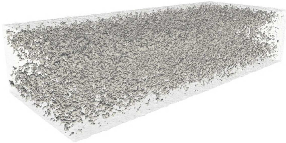
FIGURE 3.33. – Représentation 3D des pores dans une zone de 4,75 \times 2,02 \times 1,04 \text{ mm}^3 au sein de la partie utile de l'éprouvette CS(Q + V)
