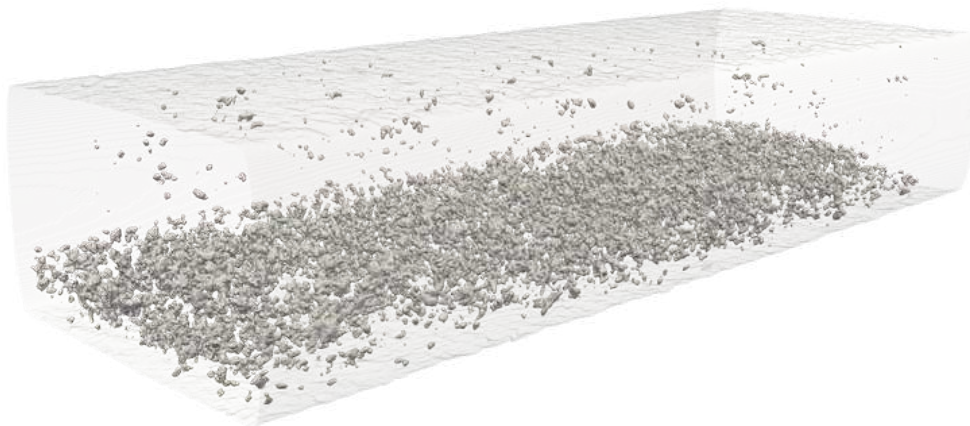
FIGURE 3.30. – Représentation 3D des pores dans une zone de 4,75 \times 1,88 \times 0,96 \text{ mm}^3 au sein de la partie utile de l'éprouvette G(Q + V)
