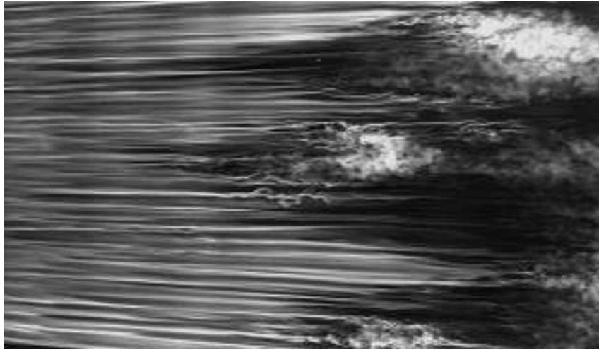
FIGURE 1.7 : Visualisation de streaks dans un écoulement transitionnel allant de gauche à droite à 6m/s. Repris de ALFREDSSON et MATSUBARA (2000)
