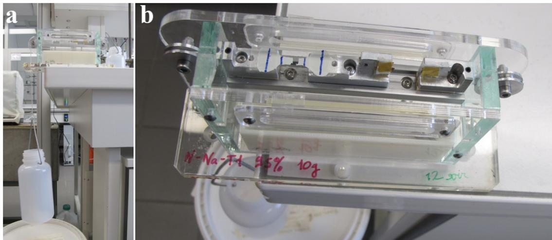
**Figure.II-12** : Photos du montage mécanique utilisé pour déterminer la contrainte de rupture des films autoportés. (a) Extérieur du montage : au bout du fil est attachée une bouteille qui est remplie graduellement avec de l'eau jusqu'à rupture du film autoporté. (b) Intérieur du montage : le film autoporté est scotché sur les deux pièces métalliques du montage dont une est mobile et attachée au fil extérieur.
