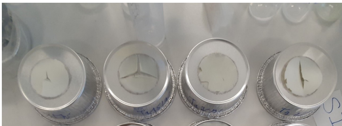
Figure.II-2 : Films autoportés préparés pour les mesures de traction mécanique. Plusieurs des dépôts présentent une structure cassante après séchage à température ambiante.
