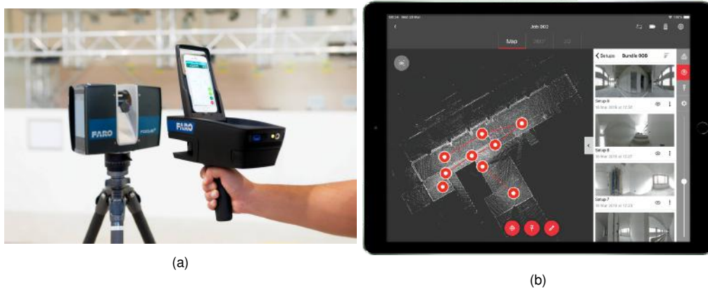
Figure 5.1 – (a) Le système FARO ScanPlan avec un TLS de la même marque (b) Application mobile du Leica RTC 360 sur tablette pour le suivi du déplacement du TLS et l'évolution du nuage de points.
