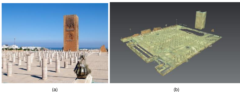
Figure 4.7 – (a) L'esplanade de Hassan à Rabat (Maroc). (b) Nuage de points 3D de cette esplanade après 17 scans.
