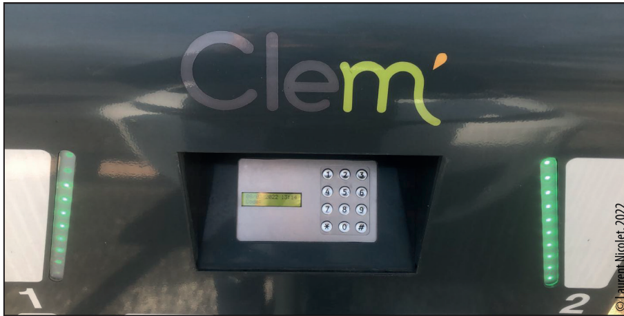
■ Photographie 11. Pavé numérique en remplacement des écrans tactiles pour simplifier le parcours usager
