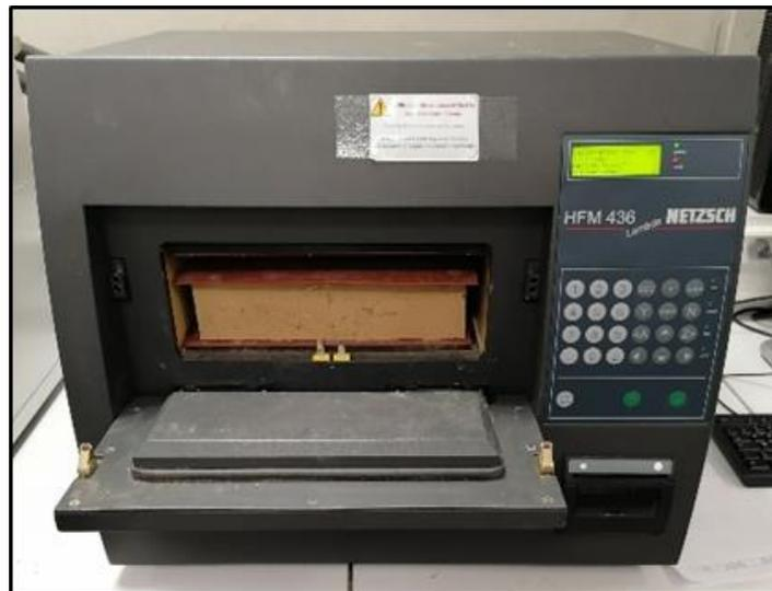
**Figure 49** : Fluxmètre thermique (HFM Netzsch HFM 436 Lambda)
