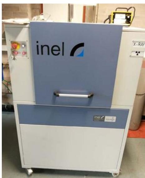
**Figure 34** : Diffractomètre, modèle Inel Equinox 3000
