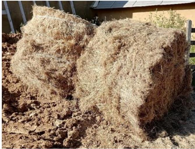
**Figure 17** : Paille de lin sous forme de balle (projet CobBauge)
