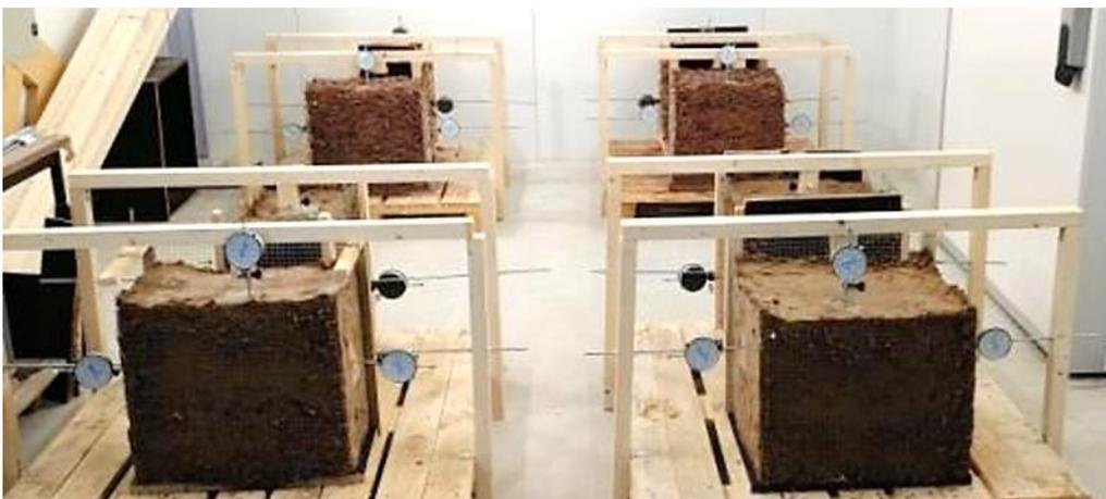
**Figure 88** : Dispositif expérimental des échantillons avec les comparateurs
