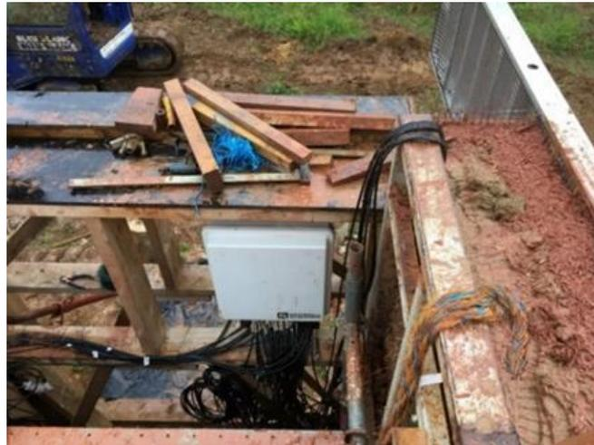
**Figure 52** : Capteurs connectés à la centrale d'acquisition
