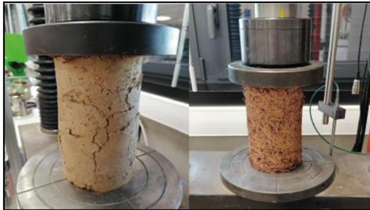
**Figure 47** : Essai de compression uniaxial
