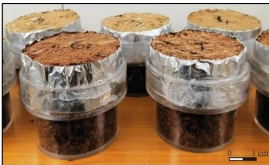
Figure 46 : Essai expérimental de perméabilité à la vapeur d'eau
