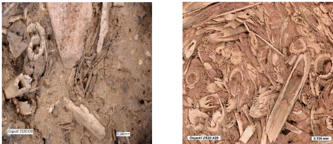
Figure 97 : Section d'un échantillon de bauge ( à gauche ) et de terre allégée ( à droite )
