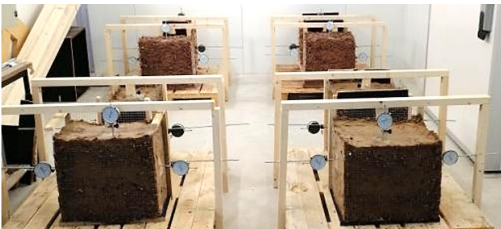
Figure 88 : Dispositif expérimental des échantillons avec les comparateurs
