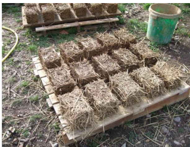
Figure 11 : Briques de terre allégée de la Maison de Soufflenheim (S'Lehmbau Atelier, 2017)
