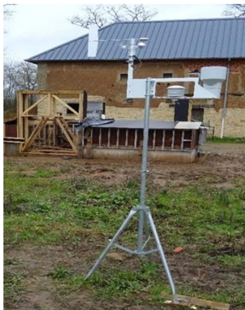
Figure 53 : Station météorologique WS-GP1
