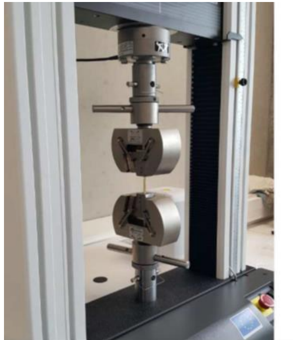
Figure 38 : Dispositif expérimental d'essai de traction des fibres (Phung, 2018)
