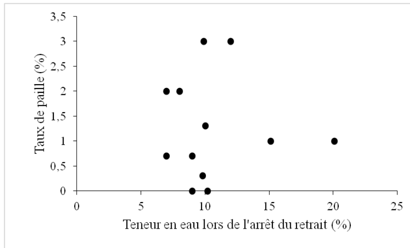
Figure 26 : Retrait par séchage des échantillons de bauge (Akinkurolere et al. , 2006)
