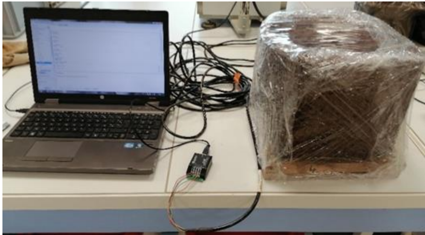
Figure 56 : Mesures de la teneur en eau volumique, de la température et de la permittivité diélectrique
