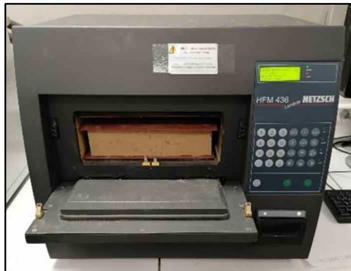
Figure 49 : Fluxmètre thermique (HFM Netzsch HFM 436 Lambda)
