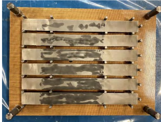
Figure 4.15 – Positionnement des éprouvettes sur le moule avec la toile métallique, avant positionnement des substrats supérieurs. On peut noter l’imprégnation de la toile métallique par la colle au contact simple de l’adhésif.
