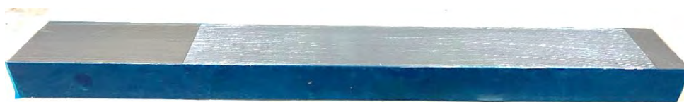
Figure 4.13 - Placement des rubans adhésifs sur les côtés latéraux pour faciliter le retrait de surplus d’adhésif débordé.
