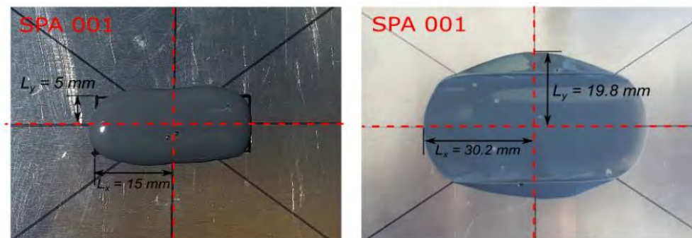
Figure 2.21– Répartition de l'adhésif avant l'essai et après la polymérisation pour l'essai SPA001.
