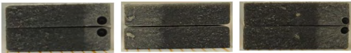
Figure H.2 - Exemples de faciès de rupture en volume pour l'adhésif EC2216 seul (10000 :5)
