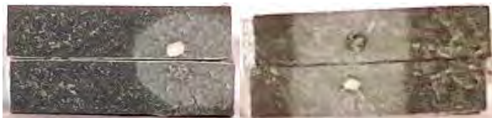
Figure 3.8 – Exemples de faciès de rupture avec des amas de particules comme défaut critique.
