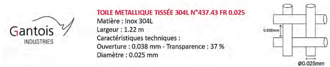
Figure 4.10 – Dimensions et format de la toile métallique Gantois en Inox 304L (Gantois, n.d.).
