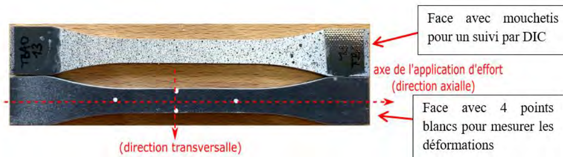
Figure 3.11 - Faciès des éprouvettes préparées pour les mesures avec le DIC (haut) et le DEO (bas).
