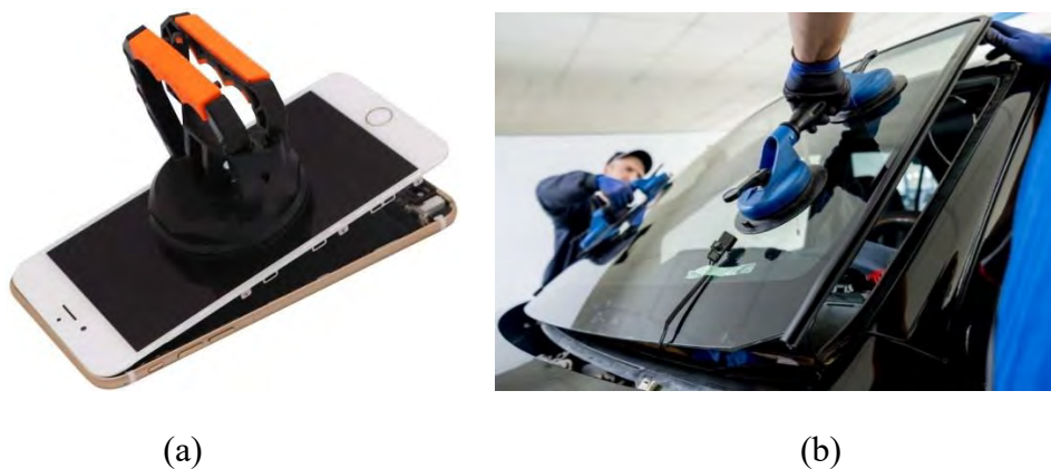
Figure 4.2 – Exemples de désassemblage mécanique : (a) verre d'un téléphone portable ( https://www.amazon.com/iphone-repair-tool-kit ), (b) parebrise d'une voiture ( https://automotiveglasseurope.com )
