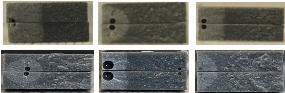
Figure H.1 - Exemples de faciès de rupture en volume pour l'adhésif EC2216 seul (10000 : 0)
