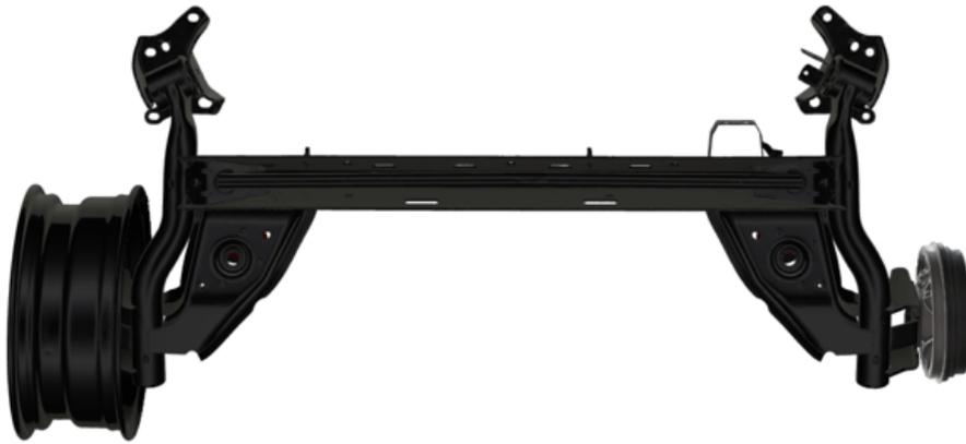
FIGURE 4.3 – Essieu arrière X98
