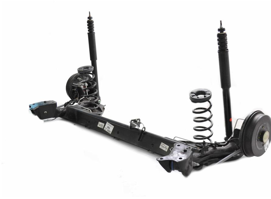
FIGURE 4.1 – Essieu arrière X52
